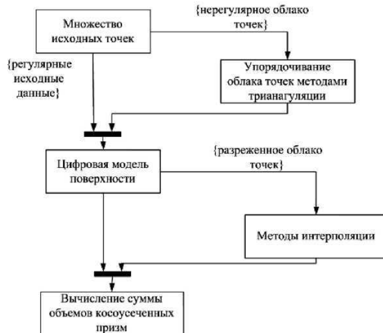
Рис. 4. Общий алгоритм функционирования подсистемы мониторинга объема зерна в силосе
